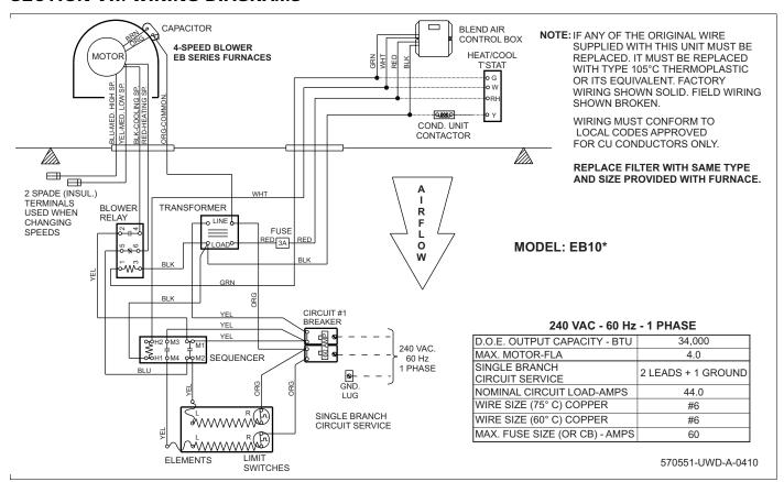
FIGURE 16: EB10\* Wiring Diagram
