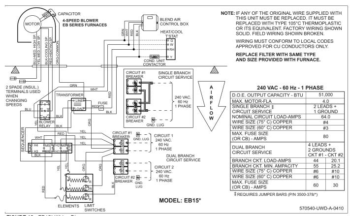
FIGURE 18: EB15\* Wiring Diagram
